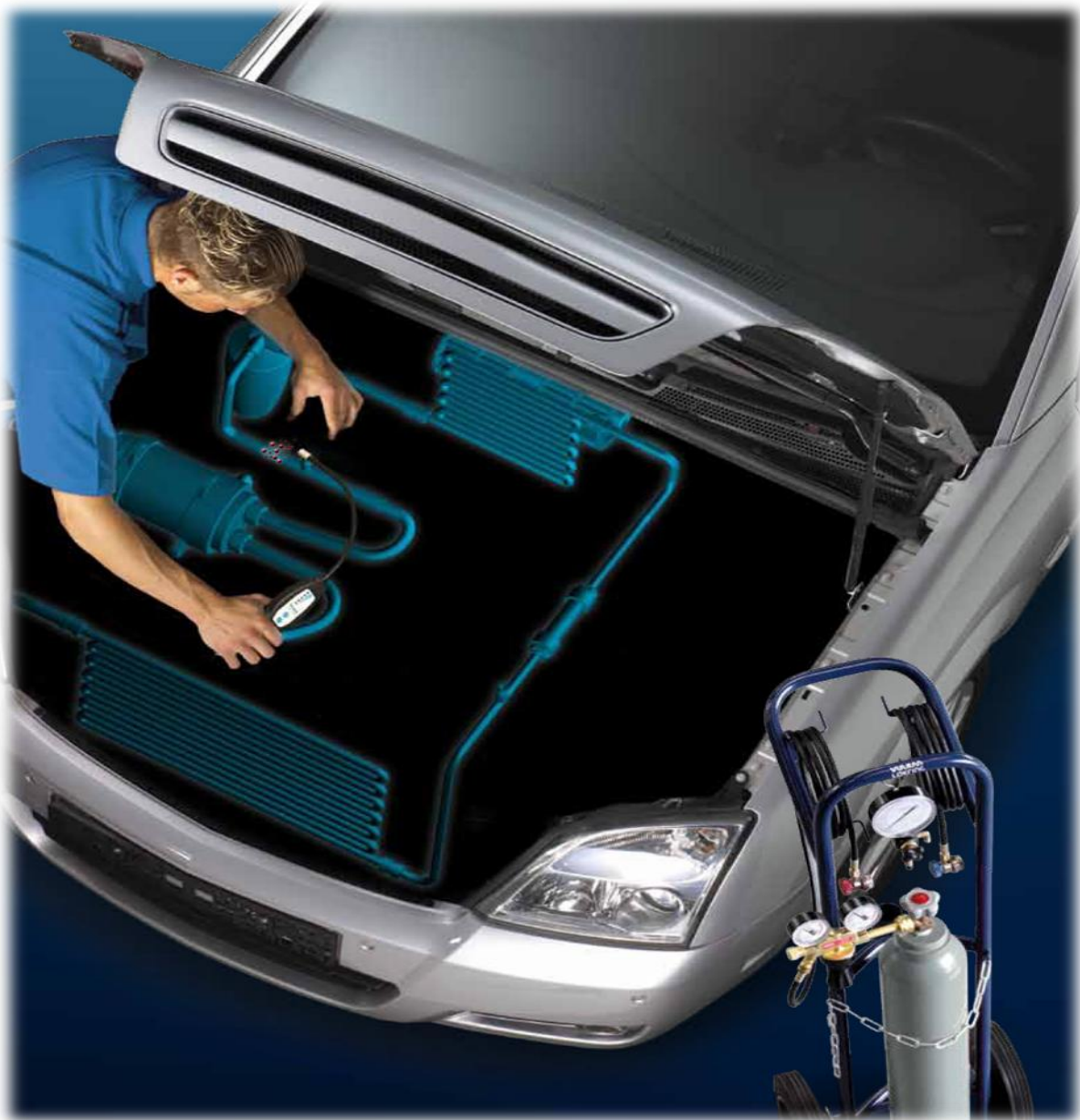
Rysunek: wykrywanie nieszczelności wokół silnika Wodór jest lżejszy od powietrza. Przewód klimatyzacyjny może być łatwo od góry sprawdzony.
